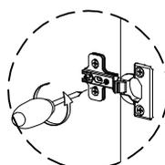
\* Apabila Pintu Samping atau Pintu Tengah saat dibuka atau ditutup menabrak pintu sebelahnya, Maka putar ke kiri baut yang ada di tengah engsel menggunakan obeng. Atau apabila Pintu terlalu mepet pada bodi samping, putar baut kearah kanan menggunakan obeng.
