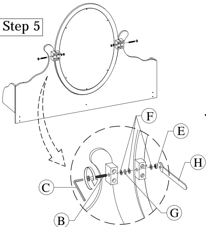
5. Pasang Cermin pada rumah laci, kaitkan menggunakan baut Jcbc M6 x 50, (dengan urutannya) Ring Besi, Ring Per, Ring Ring besi, & Ring besi, Mur. Masukkan baut pada lubang yang tersedia, putar kearah kanan searah jarum jam hingga baut terpasang rapat memakai kunci L. Tahan mur memakai kunci pas. Agar mur tidak ikut berputar.
