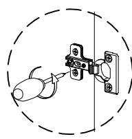
\* Apabila Pintu saat dibuka / ditutup menabrak pintu sebelahnya, Maka putar ke kiri baut yang ada di tengah engsel menggunakan obeng. Atau apabila pintu terlalu mepet bodi samping, putar baut kearah kanan menggunakan obeng.
